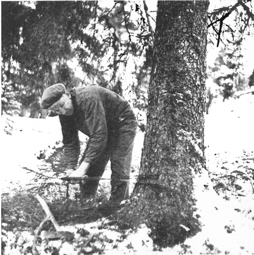
Fällsågning med timmersvans. Fjädern som går mellan handtaget på svansen och en krok i trädet kallas sågkamrat. Den underlättar sågningen.
