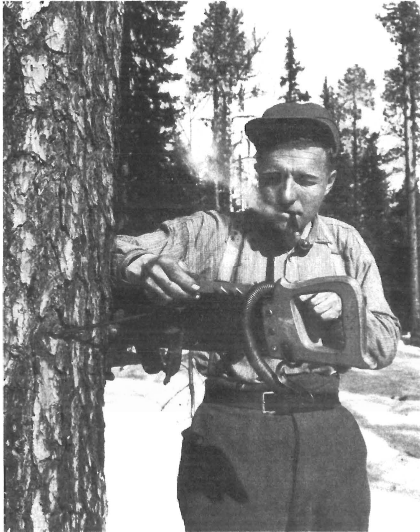
L'exploitation des forêts exige un matériel excellent et bien entretenu. Cet ouvrier est en train de limer les dents de sa scie. Photo: Inge Holm.
