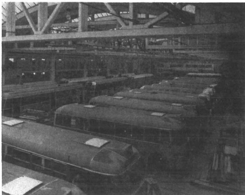
Hägglund, de Örnsköldsvik, fabrican en gran escala carrocerías de autobuses y tranvías. Foto: K. G. Kristoffersson.
