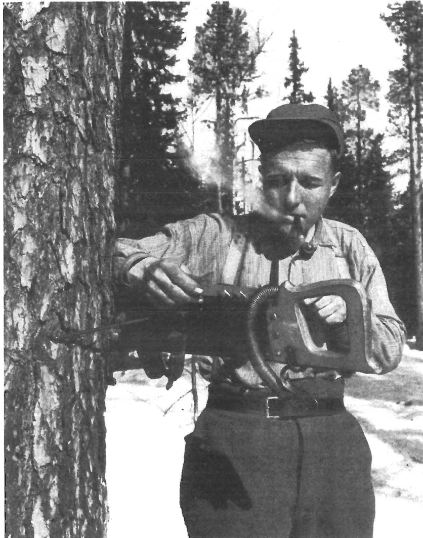
La explotación de los bosques exige un material excelente y bien cuidado. Aquí se ve un obrero limando los dientes de su sierra. Foto: Inge Holm.
